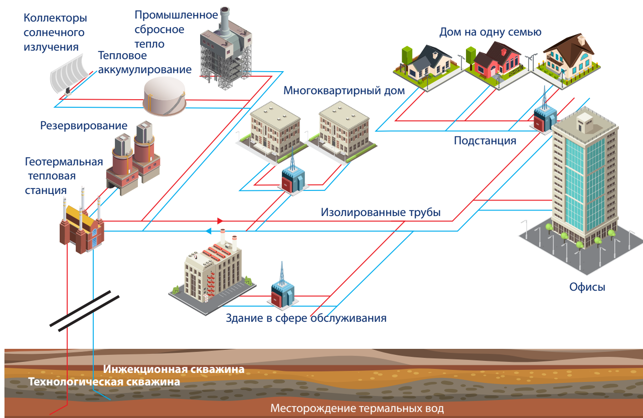
Рисунок 2. Схема системы районного теплоснабжения, в которой задействованы множественные источники энергии
