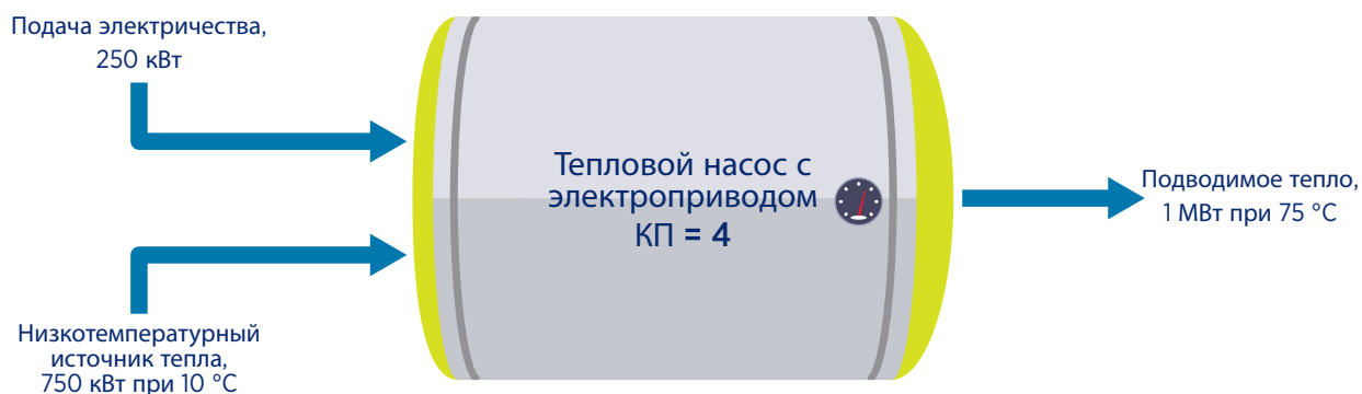
Рисунок 15. Принцип работы компрессионного теплового насоса
