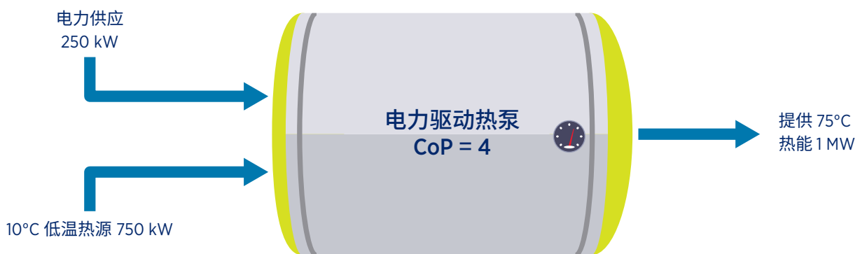
图 15：压缩式热泵的工作原理
