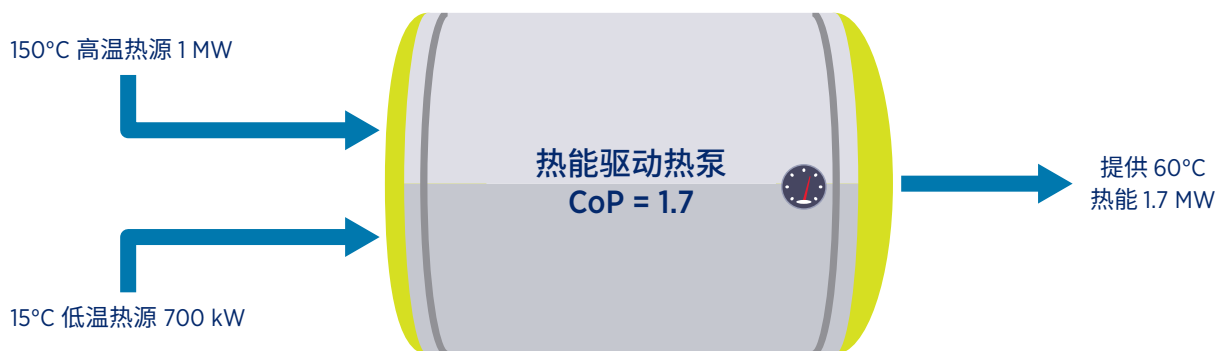
图 16: 吸收式热泵的工作原理
