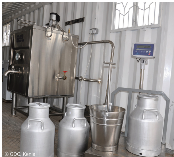
Fotografía 2 Un pasteurizador de leche geotérmico en el campo geotérmico de Menengai, Kenia
